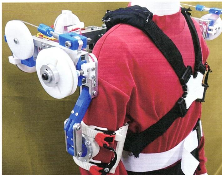
腕を長時間上げ続ける作業の姿勢保持を目的に開発した支援装置です。空圧駆動のブレーキ機構によって、制動時には装着者の腕を任意の位置で保持し、非制動時には自由に腕を動かすことができます。また、装着者の動作を妨げず拘束感の少ない本研究室独自の外骨格機構を採用しています。
